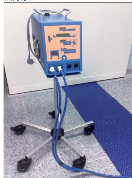
Obrázek 1. Přístroj pro extravaskulární chlazení pomocí podušek s kapalným médiem HICO – VARIOTERM
