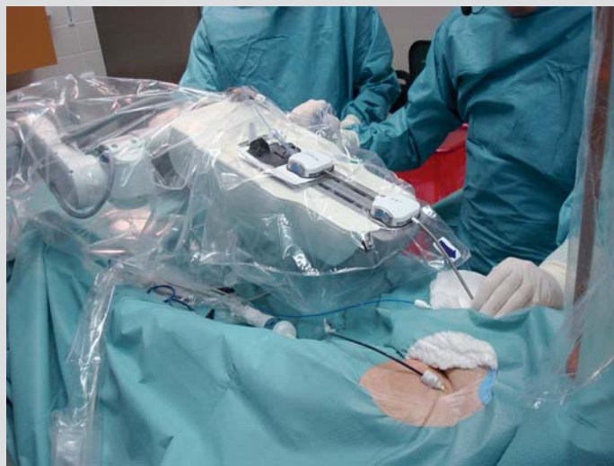
Obrázek 3a. Součástí elektromechanického robotického systému Sensei. Manipulátor, který zajišťuje pohyb robotického katétru Artisan v srdci pacienta, je namontován na katetrizačním stole a vlastní katétr je zaveden do femorální žíly přes 14 F zavaděč
