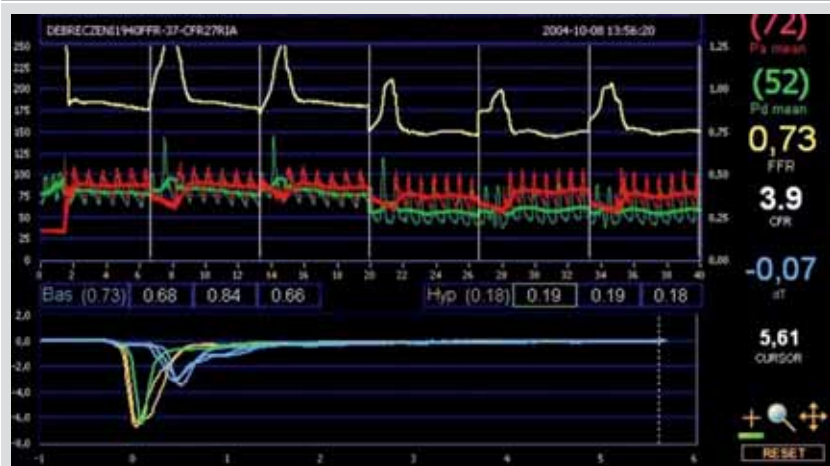
Obrázek 8. Simultánní měření FFR a CFR thermo (patologická hodnota FFR 0,73 a téměř normální hodnota CFR 3,9 pravděpodobně v důsledku technické chyby měření)
