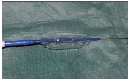
Obrázek 8. Připravená chlopeň v testovací trubici
