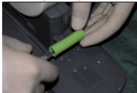
Obrázek 8. Připravená chlopeň v testovací trubici
